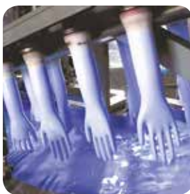
► Trempage en cours
