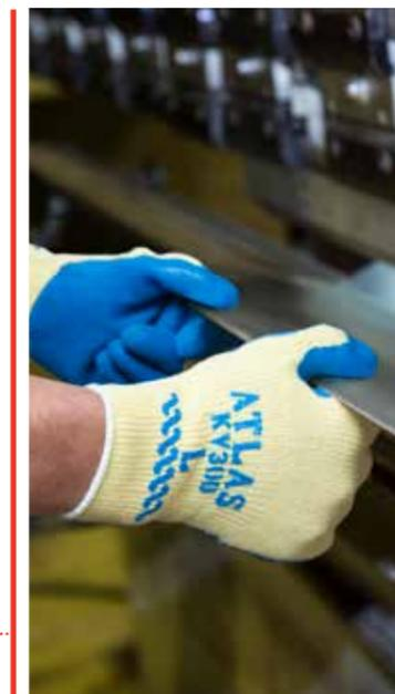
Au niveau de la paume, le KV300 est fabriqué avec une enduction de latex de caoutchouc naturel, tandis que le KV350 est fabriqué avec une enduction de nitrile. Les deux modèles offrent une adhérence durable et sont munis d'une doublure sans couture en Kevlar®. Ce sont les gants idéaux pour la manipulation des équipements lourds, du verre et des fenêtres.
